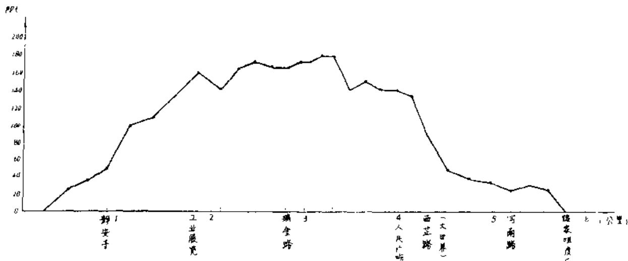
图 3.1.2b 81年12月29日20:58—21:09市区延安路(24公里弧) \text{SF}_6 浓度分布曲线
